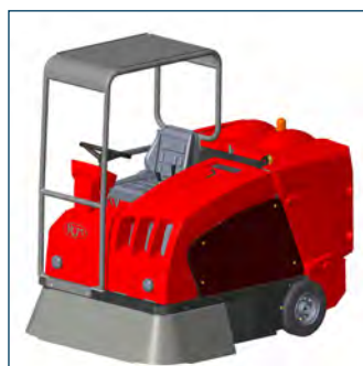
Bestuurderskap en werklampen op aanvraag / Toit de protection et feux de travail sur demande
